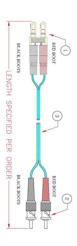
REQUIRED LENGTH TOLERANCE: +10.0cm / -0.0cm CORNING OPTICAL FIBER CABLE 50/125um, 10-GIG AQUA ZIPCORD 2.00mm
